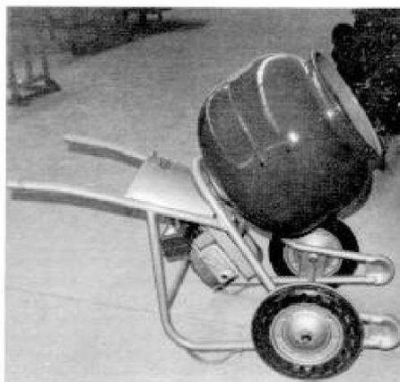
La puesta en marcha mediante manivela presenta el peligro de retroceso provocando accidentes en brazo y muñeca. Por lo tanto, debe exigirse la construcción de manivelas y otros sistemas de arranque que obtengan el desembrague automático en caso de retroceso (figura 9).
